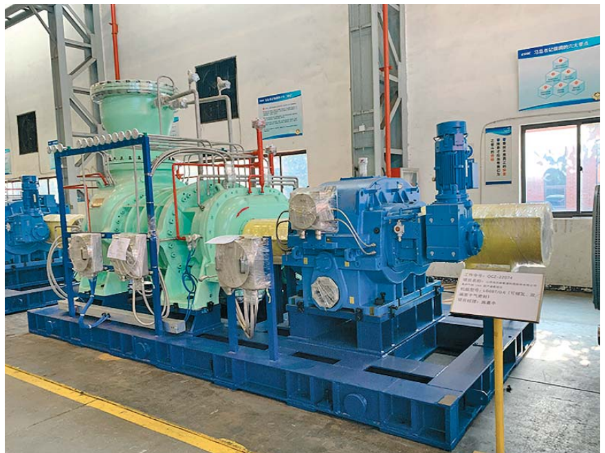
Рис. 2. Винтовой компрессор производства CSSC, г. Шанхай
