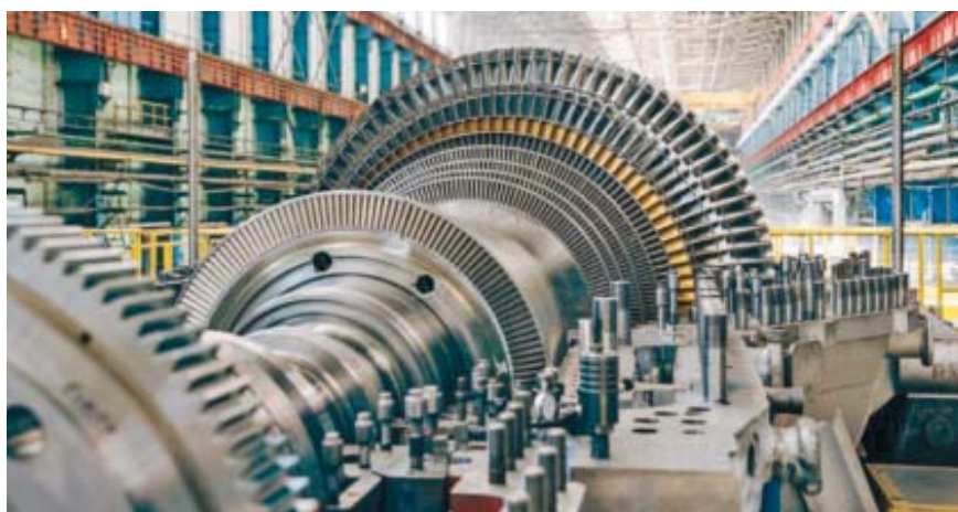
Рис. 1 Сборка паровой турбины на стенде завода
