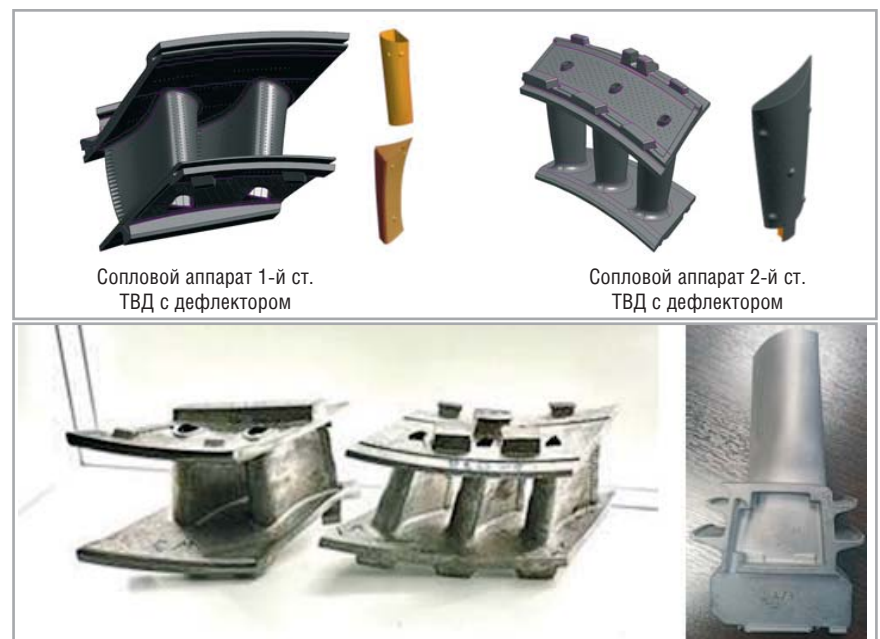
Рис. 8. Отливки сопловых аппаратов и рабочей лопатки 1-й ступени ТВД
