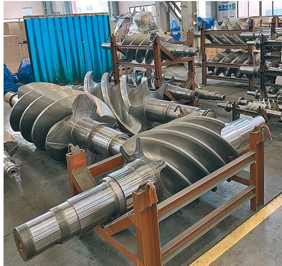
Рис. 1. Производство винтовых пар компрессоров института CSSC, г. Шанхай
