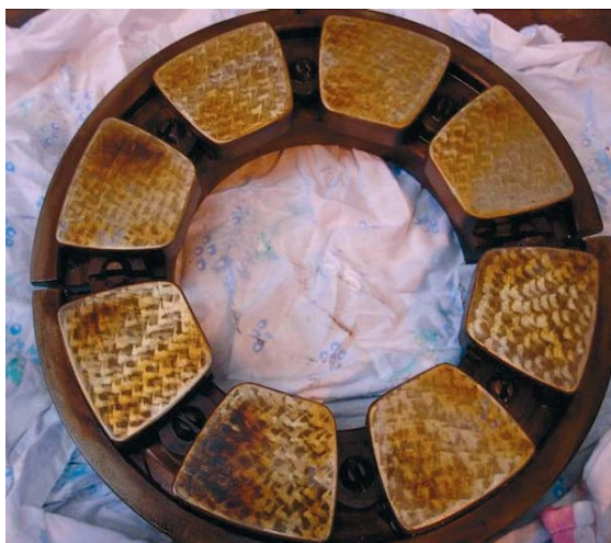
Рис. 2. Лаковые отложения на элементах подшипников
