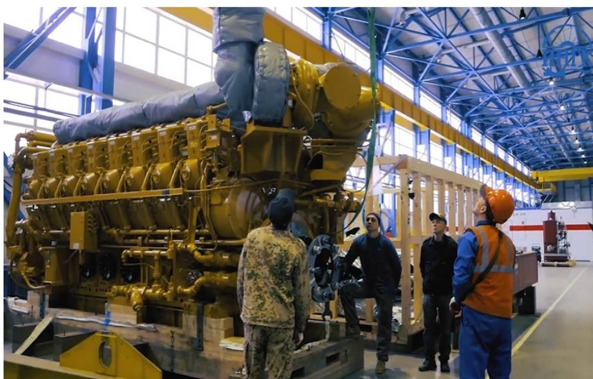
4.2. В первой половине августа 2020 года выполнена отгрузка 4-го комплекта ПКУ017 мощностью 960 кВт, с поршневым компрессором JGJ/6 производства «Ariel» и электродвигателем «Siemens» 1NB1506-4AA804AA0-Z на Чинаревское месторождение для нужд ТОО «MSI», в дополнение к трем, ранее изготовленным ИНГК и уже эксплуатирующимся на данном месторождении.
