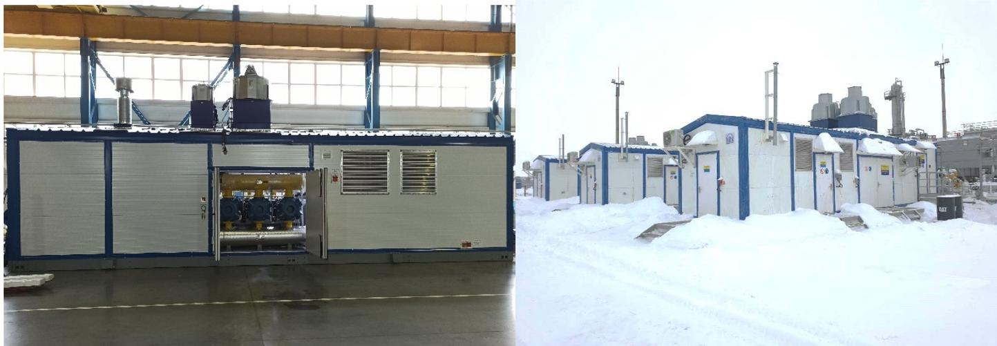
4.3. Параллельно была изготовлена и отгружена заказчику модульная ПКУ-019 мощностью 450 кВт с поршневым компрессором JGJ/4 производства «Ariel» и электродвигателем BA355MLC4BY2,5 производства «Siemens» для Ичединского месторождения.
