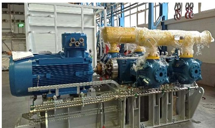
4.4. Произведено и отгружено оборудование для Комплекса деасфальтизации ООО «ЛУКОЙЛ-Волгоград нефтепереработка» в г. Волгоград. Электроприводной газоперекачивающий агрегат (ЭГПА-0201) мощностью 1,7 МВт серии «Иртыш» с центробежным компрессором «Thermodyn» и электродвигателем «Siemens». Этот проект является первым, на котором ООО «ИНГК» применило информационно-управляющую систему "Сириус" собственной разработки - для управления ГПА с центробежным компрессором.
