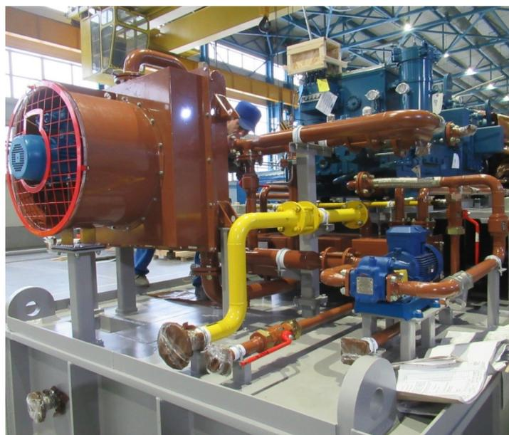
15. Начались монтажные работы двух Поршневых компрессорных установок **ПКУ 010** мощностью **3,5 МВт** полной заводской готовности на раме для нужд АО «Востсибнефтегаз» на Юрубчено-Тохомском месторождении.
