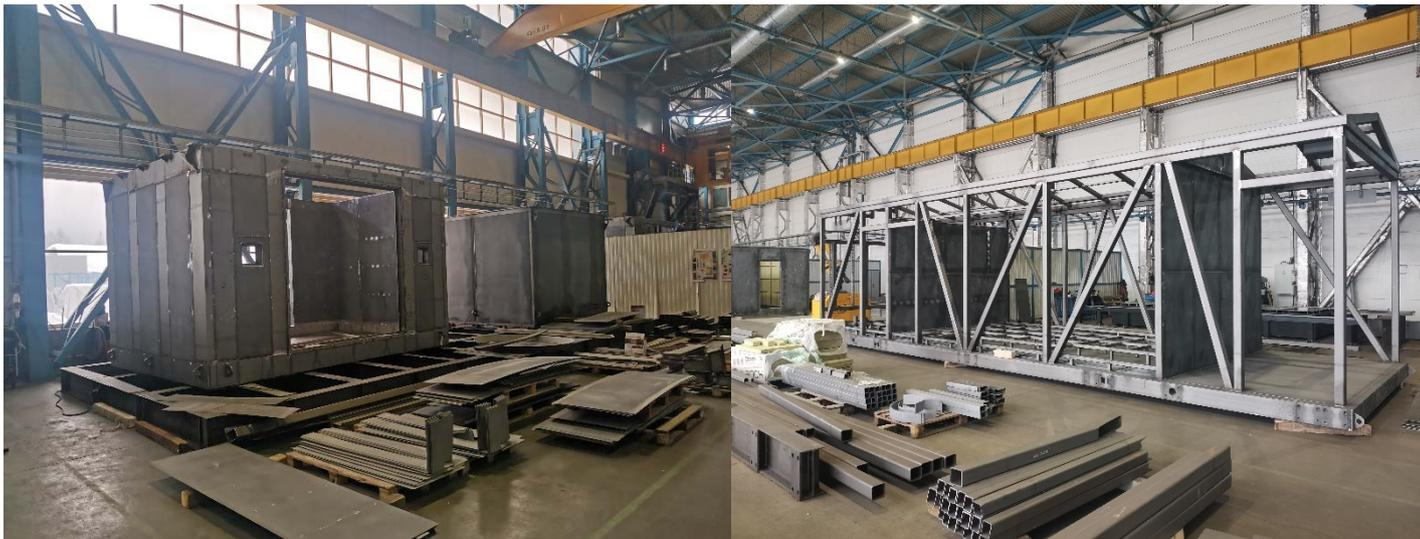
Конструкторская документация передана в производство и в цехах компании уже началось изготовление **2-х** комплектов **ГПА-16 МВт «Иртыш»** для проекта. В настоящее время на сборочно-сварочных участках завода идет изготовление рамы, блока управления, блока подготовки топливного газа. Ведется сборка элементов и основных узлов ГПА.
