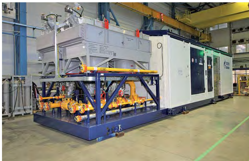
Рис. 4. Мобильная компрессорная установка производства ООО «ИНГК»
