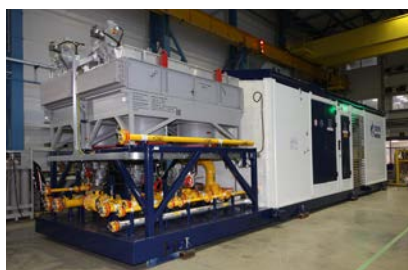
Рис. 3. Мобильная компрессорная установка МКУ-001 мощностью 200 кВт на базе единого интегрированного мотор-компрессора ICL производства Baker Hughes
