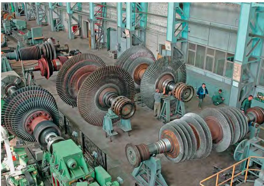
↻ В цехе ремонта роторов паровых турбин
