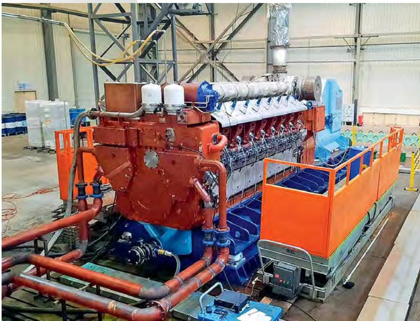
С Испытания газопоршневой установки 4000GF-T для Черногорской ТЭЦ
