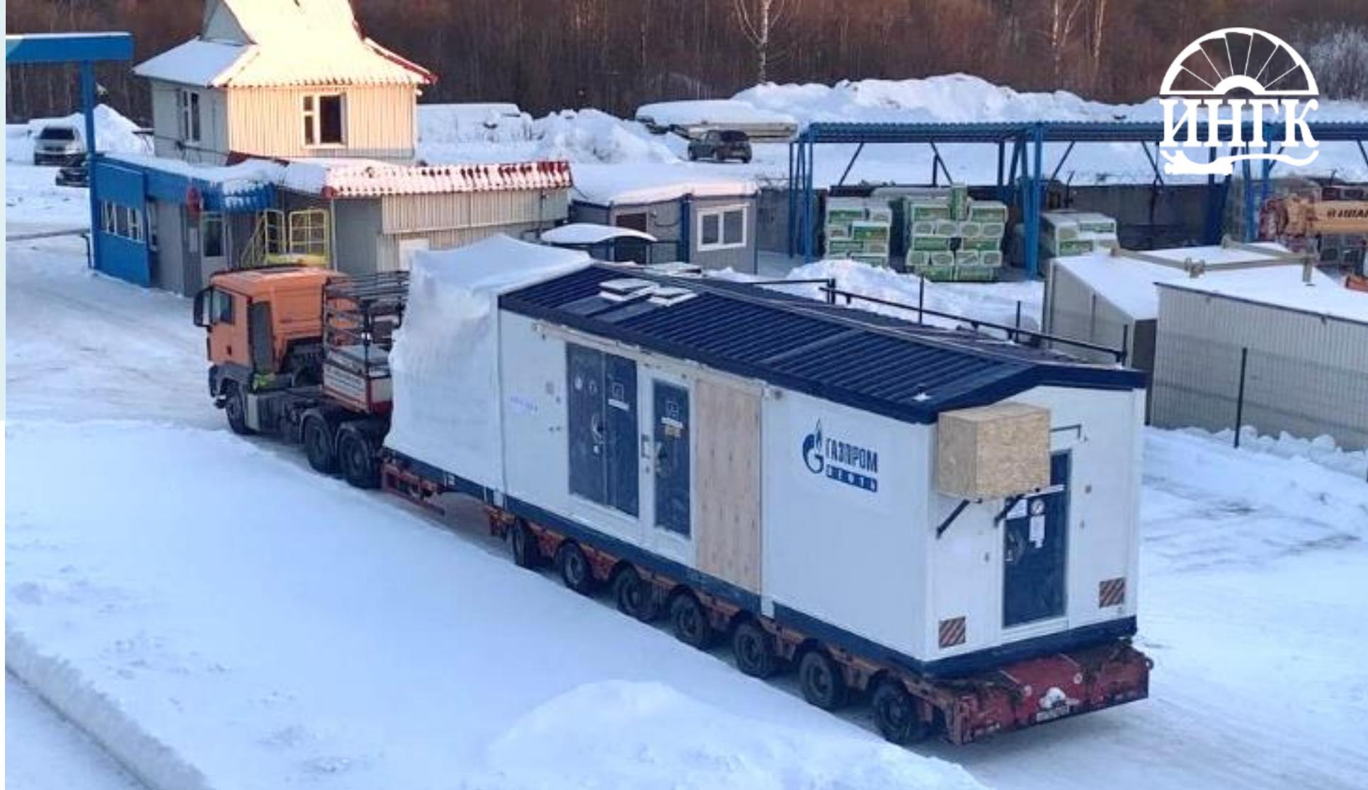
МКУ на базе интегрированного мотор-компрессора «ICL» является новым типом компрессорных установок для сжатия низконапорных газов, у которого исключены недостатки применяемых в настоящее время типов КУ с винтовыми компрессорами, и может послужить очень серьезной альтернативой существующим затратным решениям МКУ на базе винтовых компрессоров (имеющих существенные недостатки - по сравнению с решением, разработанным специалистами ООО «ИНГК» в кооперации с компанией «Thermedyn» («Baker Hughes»))
