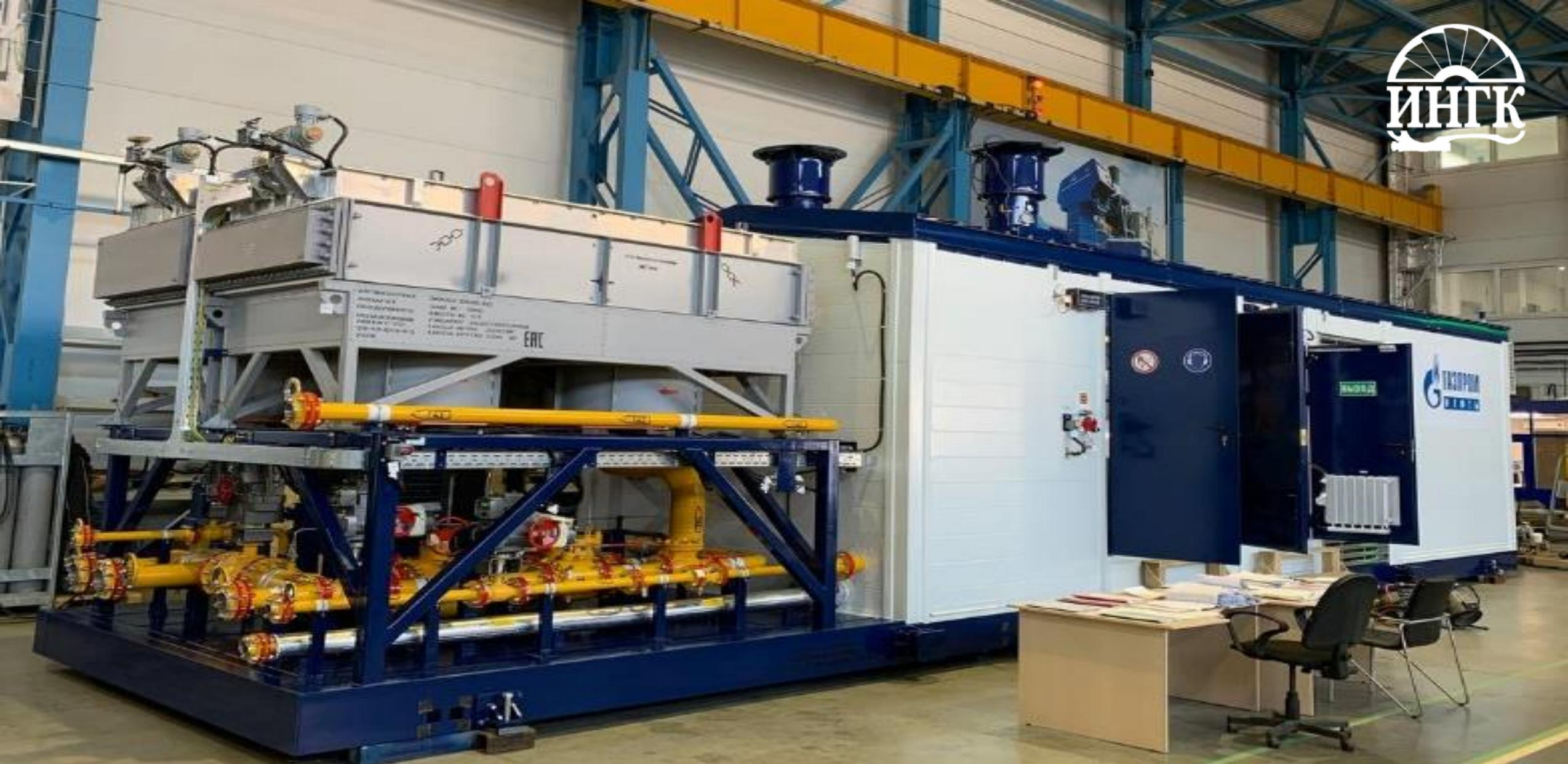
На производстве ООО «ИНГК» изготовлена первая в РФ «Мобильная компрессорная установка» (МКУ-001) мощностью 200 кВт на базе единого интегрированного мотор-компрессора «ICL» (пр-во «Thermodyn», Франция) с ЭЧР (Заказчик - ООО «Газпромнефть-Снабжение», для объектов АО «Газпромнефть - Ноябрьскнефтегаз» в ЯНАО).
