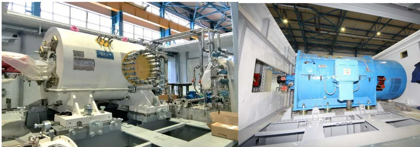
4. Полностью завершены работы над проектом «Мобильная компрессорная установка» (МКУ-001) мощностью 200кВт с единым интегрированным мотор-компрессором «ICL» (производства компании «Thermodyn», Франция) с ЭДВ с ЭЧР -
