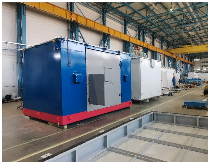
Второй этап: два комплекта Блок системы воздухоочистки и Блок системы вентиляции, изготовленные ООО «ИНГК», сданы отделу технического контроля АО «ОДК-Авиадвигатель» и подготовлены к отгрузке.
