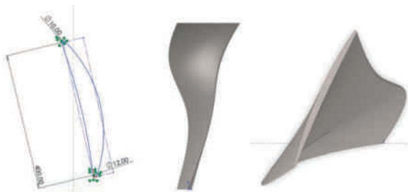
Рис. 2. Профиль лопатки нового поколения, используемой на двигателе Boeing 737-8 max
