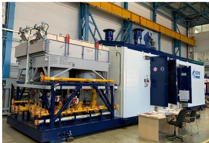
В основе МКУ-001 применено проектное решение Патента НТЦ ПАО «Газпромнефть» RU 2692859 С1 «Способ использования углеводородного газа и модульная компрессорная установка для его осуществления» для объектов АО «Газпромнефть-Ноябрьскнефтегаз» в ЯНАО.
