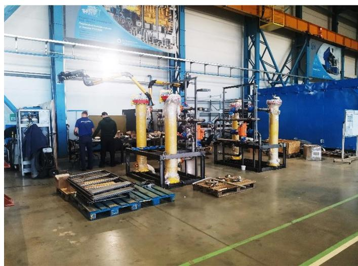
3. На производственной площадке завода ООО «ИНГК» в г. Пермь продолжается **изготовление блоков и систем** (компонентов ГПА) для АО «ОДК-Авиадвигатель».
