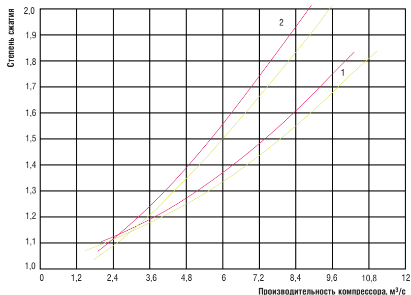
Рис. 7. Газодинамические характеристики ЦБК: кривая 1 - до замены системы магнитного подвеса; кривая 2 - после замены системы магнитного подвеса
