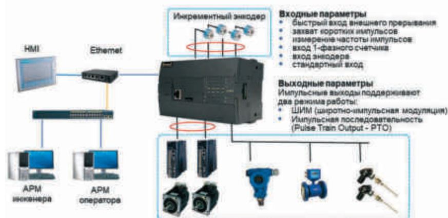
Рис. 6. Структурная схема интеграции контроллеров серии L22 в машиностроении
