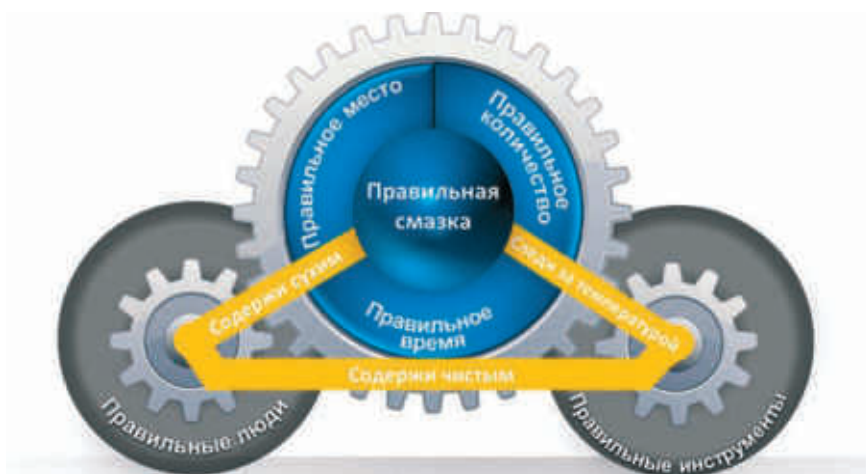
Рис. 5. Механизм надежности, обеспечиваемый прецизионным смазыванием
