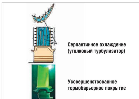
Рис. 8. Устройство охлаждения лопаток турбины
