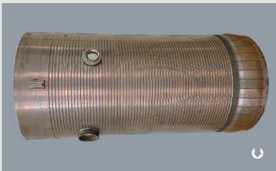
**Освоено производство важного элемента камеры сгорания ГТУ Т32.**
