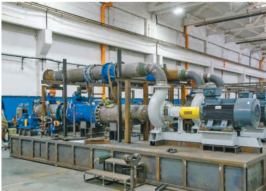
Рис. 3. Модули централизованной системы охлаждения агрегатов (находятся в производстве)
