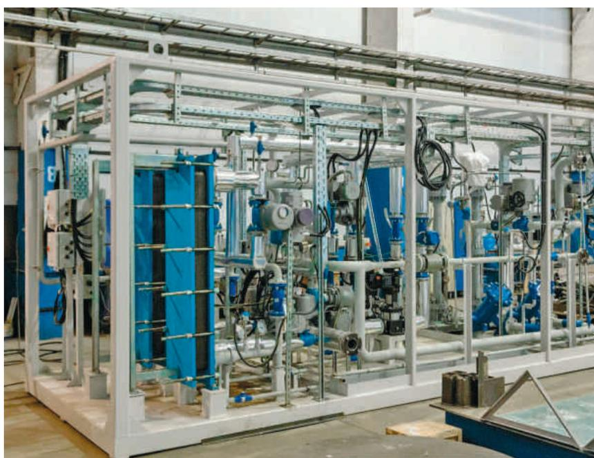
Рис. 2. Блок подогрева дизельного топлива
