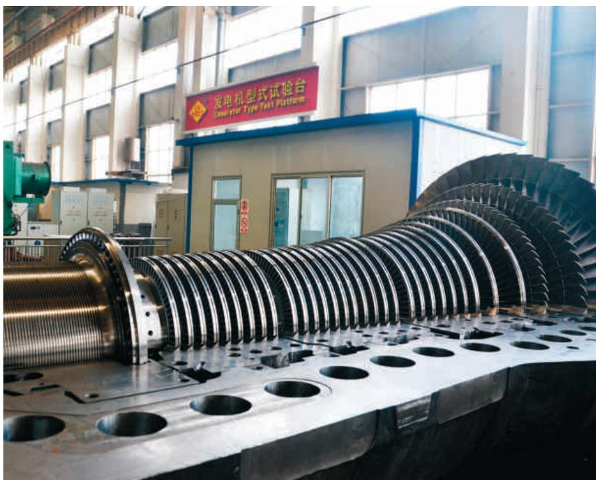
Использование в конструкции неподвижных удерживающих колец оптимально для создания цилиндра модульной конструкции, патрубков отборов и подводов пара. Это также способствует поддержанию равномерной температуры корпуса с меньшим тепловым напряжением. Модульная конструкция обеспечивает быстрый монтаж и ввод в эксплуатацию.
