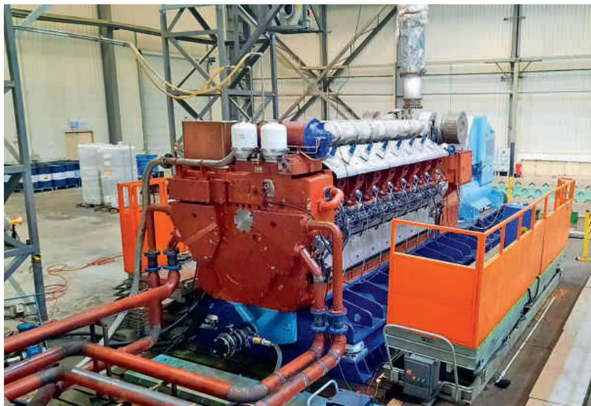
Рис. 1. Газопоршневой энергоблок 4000GF70-T на испытательном стенде
