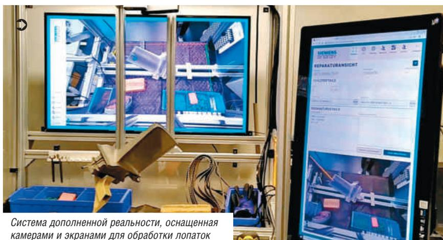
Система дополненной реальности, оснащенная камерами и экранами для обработки лопаток
