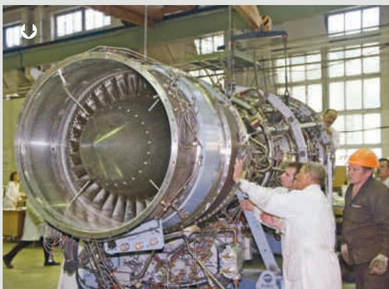
**На Южно-Сахалинской ТЭЦ-1 приступили к монтажу газотурбинных энергоблоков ГТЭС-25ПА.**
