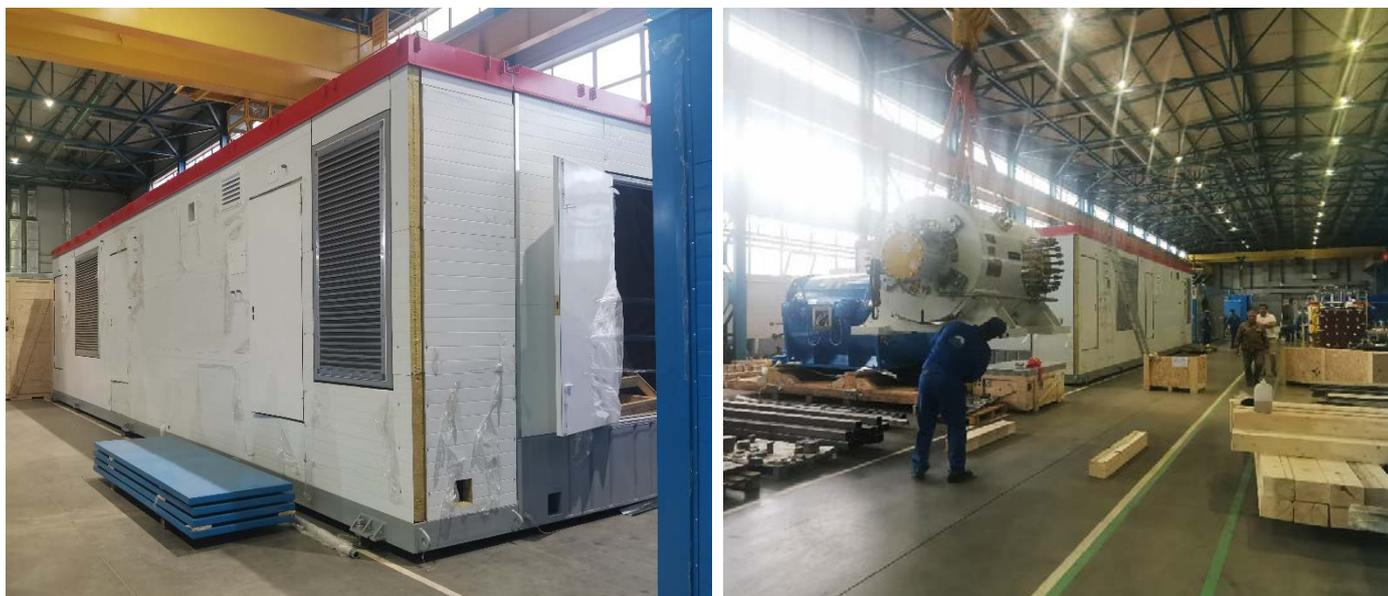
2. ООО «ИНГК» с начала августа 2021 года находится в активной фазе изготовления составных частей и компонентов **электростанции собственных нужд (ЭСН)** для объекта **«Дообустройство сеноман-аптских залежей Бованенковского НГКМ. Этап 4»** (в составе **2-х** полнокомплектных ГТЭА мощностью **12 МВт** каждый).
