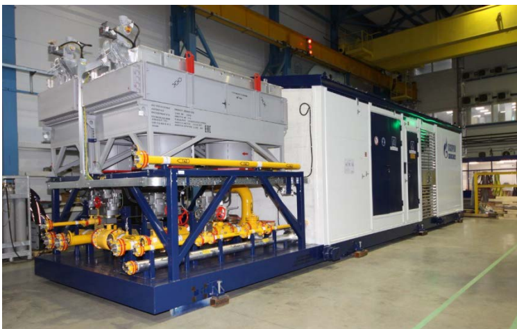
МКУ-001 на базе единого интегрированного мотор-компрессора ICL – изготовлена и отгружена Заказчику
