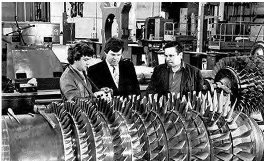
Проведение замеров рабочих лопаток осевого компрессора ротора турбокомпрессора ГТК-10
