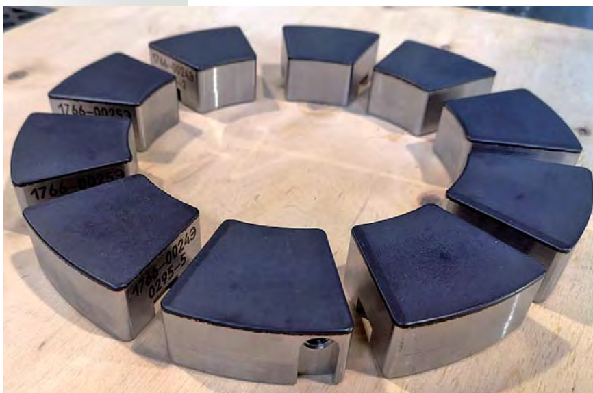
Упорные сегменты подшипника центробежного компрессора
