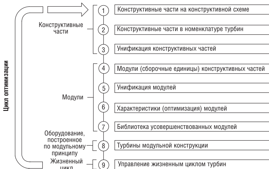
Рис. 1. Алгоритм модульного подхода создания паровой турбины и совершенствования ее конструкции при управлении жизненным циклом
