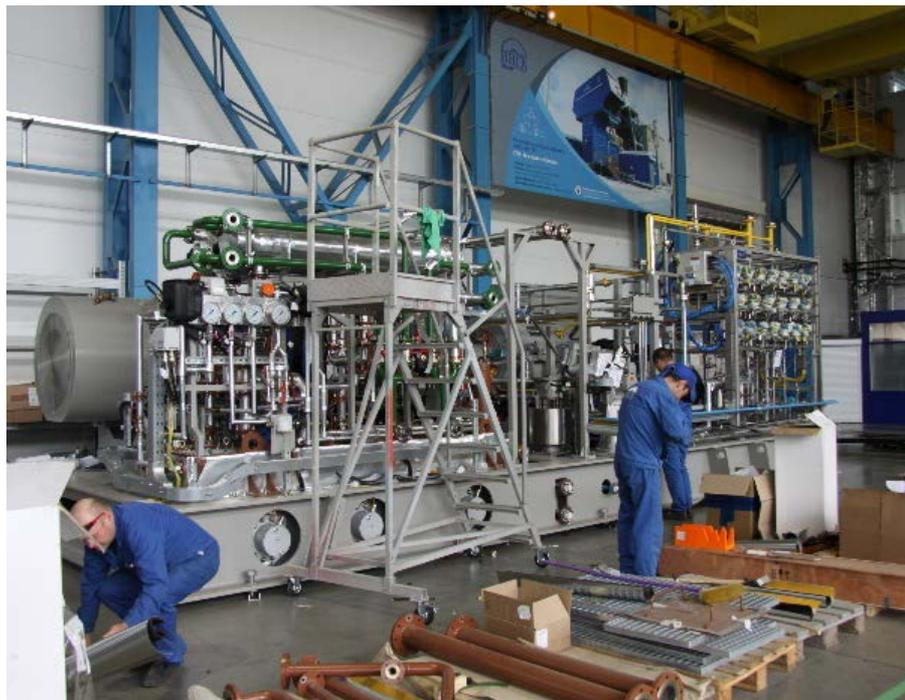
4. **Электромонтажный участок** (сборка электрощитового оборудования, выполнение комплекса электромонтажных работ)
