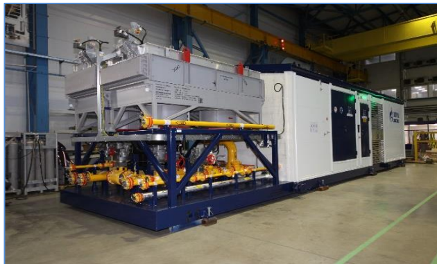
МКУ-001 на базе единого интегрированного мотор-компрессора ICL - изготовлена и готова к отгрузке Заказчику
