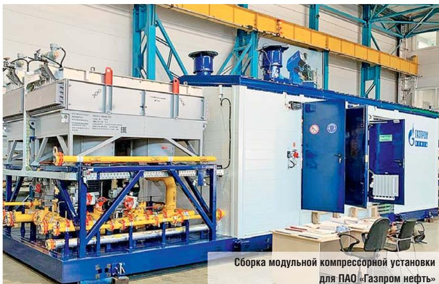
Сборка модульной компрессорной установки для ПАО «Газпром нефть»
