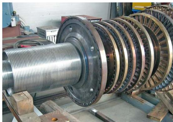
Рис. 5. Ротор турбины с теплофикационным отбором мощностью 2,5 МВт
