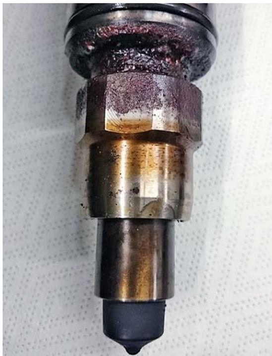
Рис. 21. Состояние корпуса форсунки после ~ 50 часов работы с 5...15% WFE и двух месяцев последующей работы двигателя
