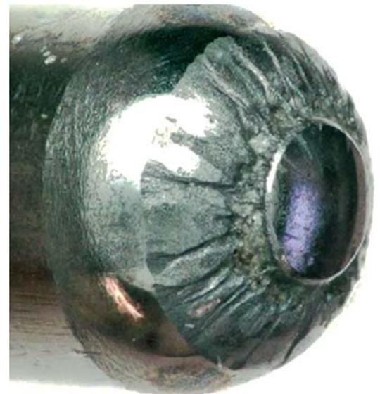
Рис. 19. Состояние штока регулирующего клапана инжектора после 50 часов работы с нагрузкой 5...15 % WFE, с сильной эрозией и раковинами из-за кавитации
