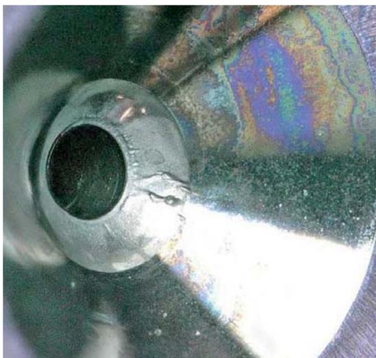
Рис. 20. Состояние седла регулирующего клапана инжектора после 50 часов работы с 5...15% WFE, с сильной эрозией и раковинами из-за кавитации
