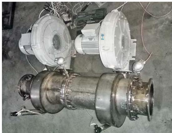
**□** Рис. 5. Двухступенчатая камера сгорания РБС2
