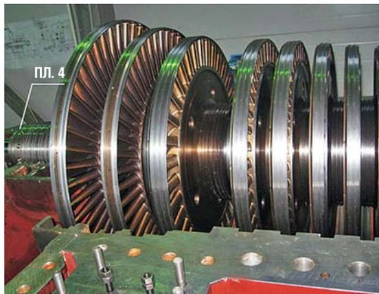
➤ Рис. 7. Дополнительная плоскость коррекции ротора турбины с теплофикационным отбором мощностью 2,5 МВт
