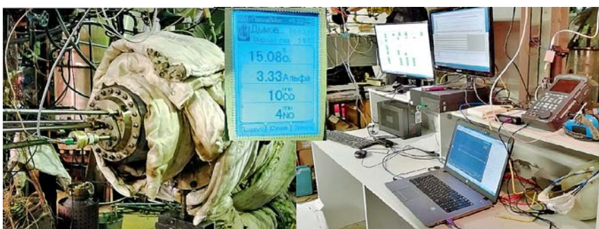
➤ Фото 4. Стендовые испытания камеры сгорания
