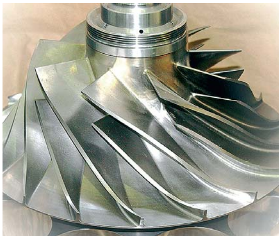
Фото 3. Рабочее колесо компрессора
