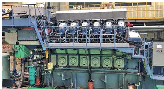
Фото 1. Двигатель HIMSSEN 12H32CV с двухступенчатой системой турбонаддува
