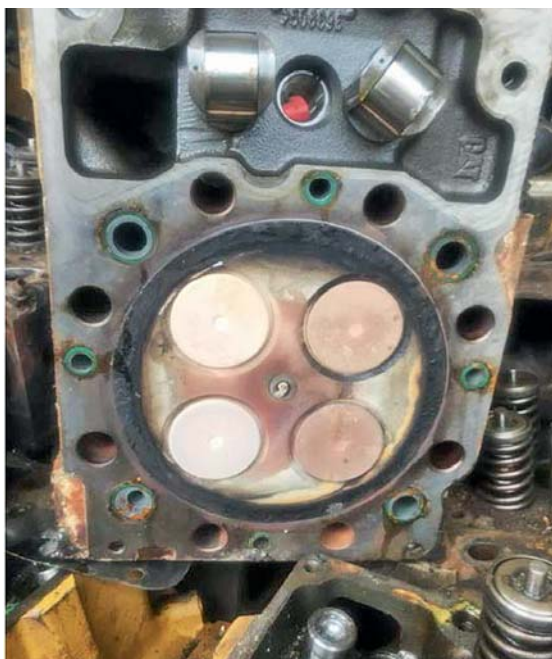
© Фото 9. Отложения на головке блока цилиндров двигателя Caterpillar, работающего на биогазе
